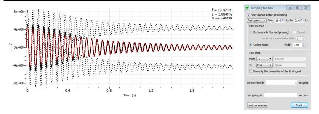
ossia un valore di frequenza propria pari a 19.47 Hz e uno smorzamento viscoso pari a 1.0848% (Nwin è il numero di finestre temporali utilizzate, cioè il numero di segmenti di segnale di lunghezza "L" sull'asse dei tempi all'interno dell'intervallo temporale definito nella sezione "Time limits", che in questo caso è l'intero tempo di acquisizione).
