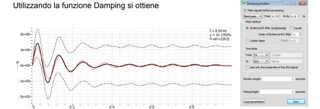
ossia un valore di frequenza propria pari a 8.95 Hz e uno smorzamento viscoso pari a 10.1795%. Da calcolo agli elementi finiti si era ottenuto 9.091 Hz, quindi una variazione di -1.55% rispetto tale ultimo valore. Dall'analisi H/V si era ottenuto circa 8.5 Hz.
