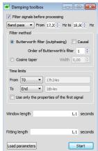
ossia un valore di frequenza propria pari a 17.72 Hz e uno smorzamento viscoso pari a 6.5922%.
