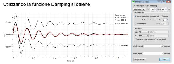
ossia un valore di frequenza propria pari a 9.22 Hz e uno smorzamento viscoso pari a 6.2645%.
