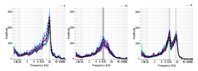
**Segnale equalizzato**: gain 2.100 (24k ohm), lunghezza finestra da 20 a 50s, bad sample thresold 50%, anti-triggering on raw signal, n° finestre 100
