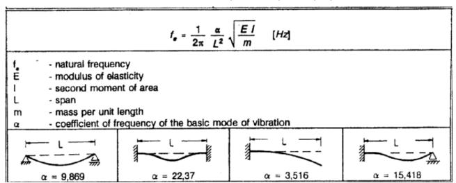
Mediando tra lo schema (2) e quello (4) si ottiene 19.77 Hz, valore prossimo a quello misurato sull'asse V.
